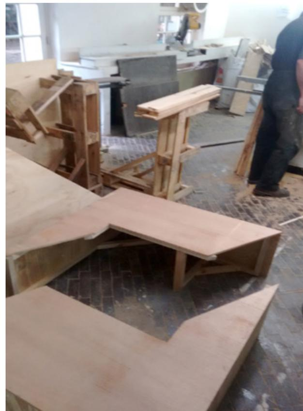
Proceso de construcción del pedestal: corte y ensamble de piezas.
