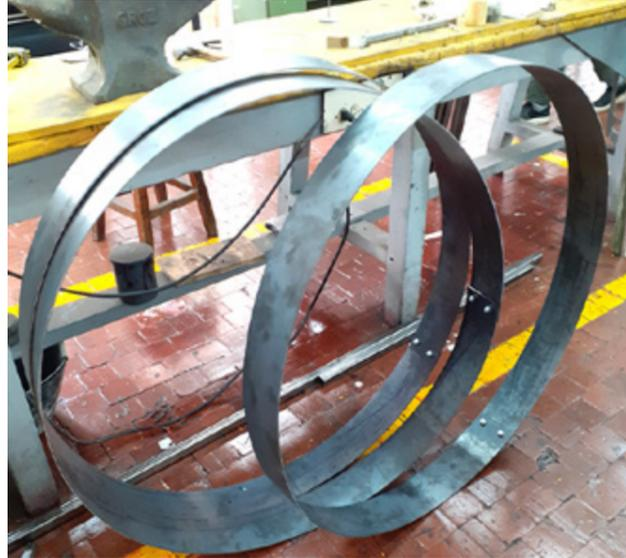
Proceso de construcción del protector M-90 corte, doblada y ensamble de piezas.
