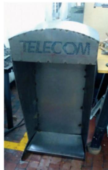
Proceso de construcción de la cabina telefónica: doblado, corte y ensamble de piezas.
